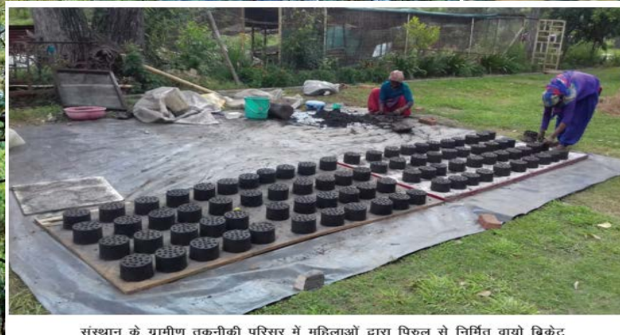
संस्थान के ग्रामीण तकनीकी परिसर में महिलाओं द्वारा पिरुल से निर्मित बायो ब्रिकेट
