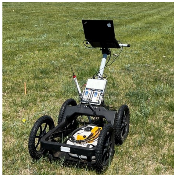
Зураг 1. Георадарын Common Offset (CO) аргачлалын хамгаалагдсан антенны хэмжилт, ажиллах зарчим. Антенд өгөх импульс болон хэмжилтийн мэдээллийг оптик кабелиар хяналтын төхөөрөмж рүү дамжуулж түүнээс цааш нь хэмжилтийн компьютерт мэдээллээ дамжуулж хадгалах замаар георадарын хэмжилт хийгдэнэ. Манай 250МГц антен тэргэнцрийн хамт хэмжилтэнд бэлэн болсон байдал
