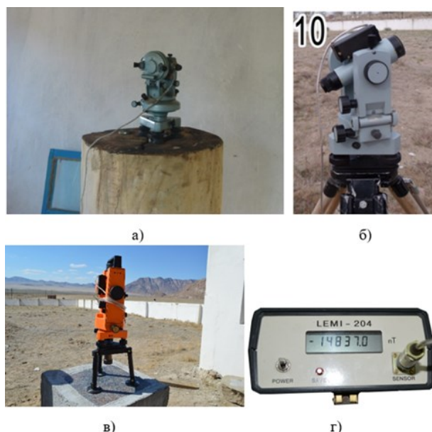
Зураг_20 а). ферросоронзон хэмжигч, б), г). Теодолит 2Т30П ба LEMI-204, в). Теодолит 3Т2КП (1секундын алдаатай)
