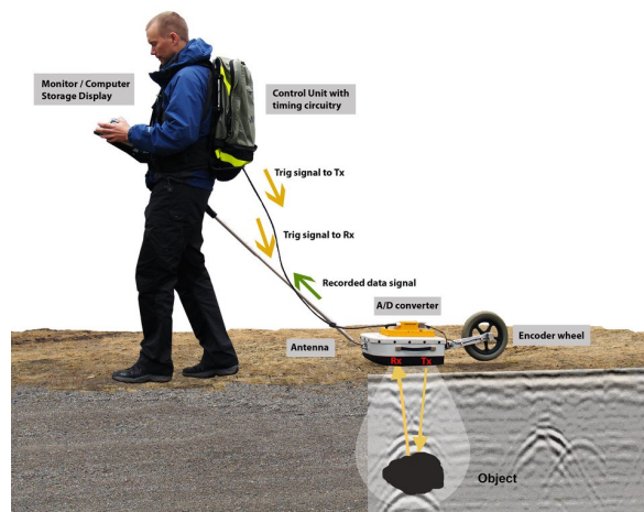
Зураг 2. Георадарын Common Offset (CO) аргачлалын хэмжилт. Хэмжилтийн алхам хэмжигч дугуйгаар замаа хэмжинэ, антенд өгөх импульс болон хэмжилтийн мэдээллийг оптик кабелиар хяналтын төхөөрөмж рүү дамжуулж түүнээс цаашир нь хэмжилтийн компьютерт мэдээллээ дамжуулж хадгалах замаар георадарын хэмжилт хийгдэнэ.
