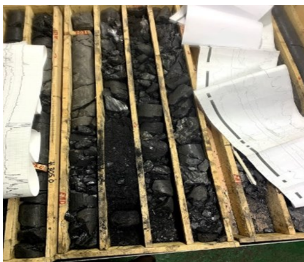
Зураг 2. Анхан шатны боловсруулалтыг нүүрсний дээжтэй тулгаж геологийн бичиглэл хийх явц
