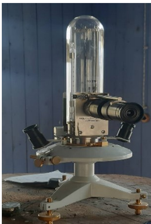
Зураг 1. QNM-1029 магнетометр
